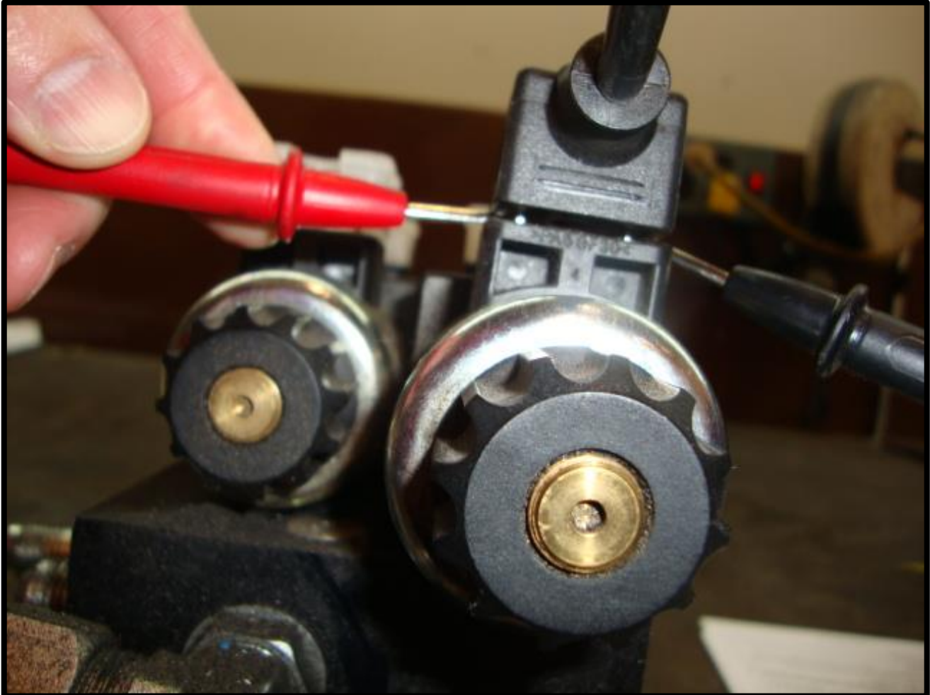
Fig. 8-2 Checking Din Plug Voltage
